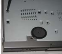
1.2. Ábra: A HDD rácsavarozása
